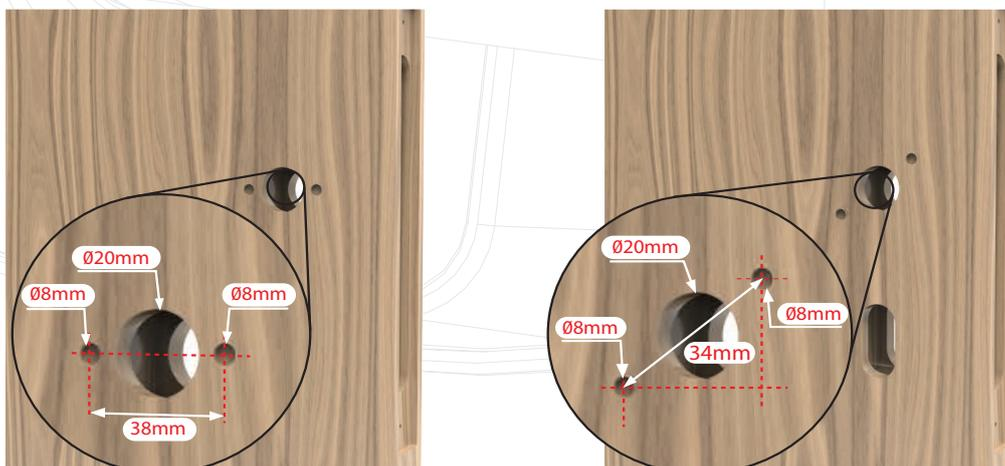
Bild 1 - Europäische Bohrungen (links) & skandinavische Bohrungen (rechts)
