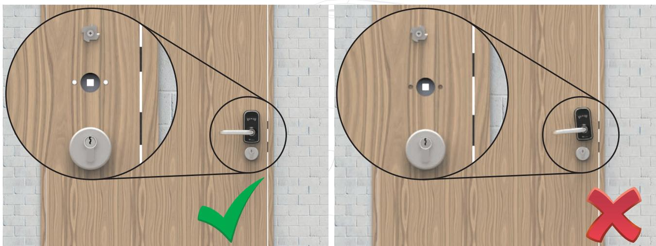
Während der Installation des PaxLock Pro an der Tür, muss das Gerät vollständig bündig an der Vorderseite der Tür anliegen. Ist dies nicht der Fall, müssen die Löcher in der Tür eventuell angepasst werden.
